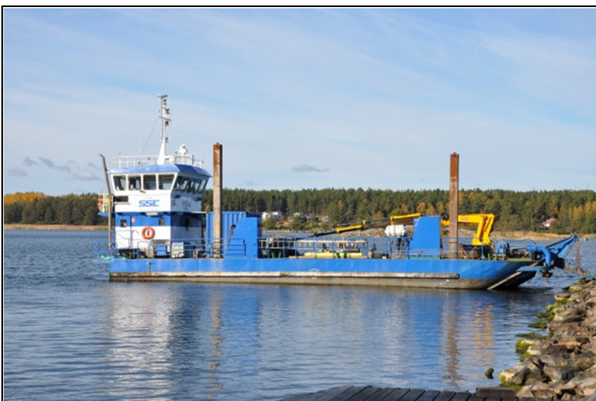
Förläggning av dricksvattenledning från fartyget som här har ankrat upp vid Schweizerdalen.
