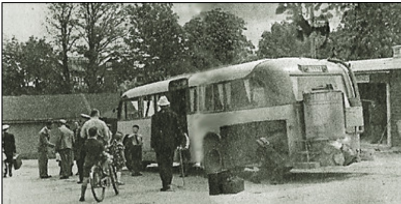
Dalarö Torg 1944. Buss nr 5 med gengasaggregat.
