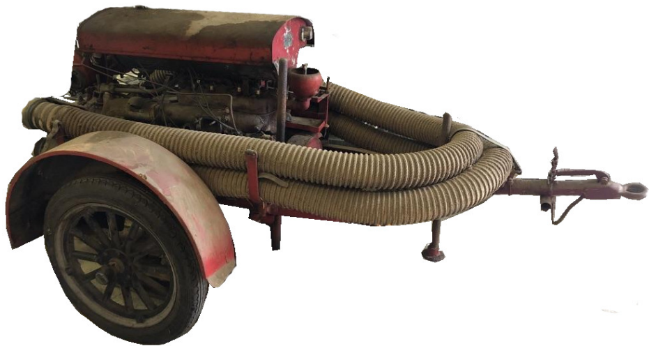
Albin Motorspruta A33 Motor: Albin 4-cylindrig sidventil Drag: 60 mm kula Kapacitet: 800 l/min
