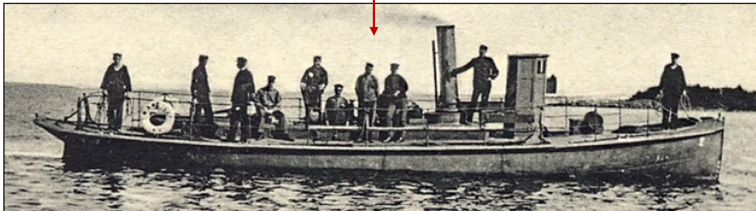
Ångslupen är en med ångmaskin försedd slup o således ett halvdäckt fartyg. Endast för- och akterdäck finns och mellan dessa ett utrymme med durkar eller – hos större ångslupar – ett nedsänkt däck.
